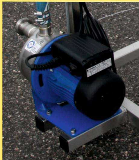
Saftpumpe mit Durchflusszählwerk
